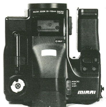
På oversiden af Miraiens objektiv er placeret et LCD-display med et væld af informationer. Men Ricoh Mirai er også det mest alsidige af »hybrid«-kameraerne.
