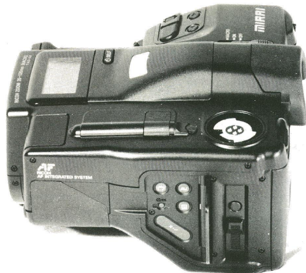
Under et dæksel på siden af Ricoh Mirai sidder knapper for kameraets mange funktioner, herunder seriefotografering, eksponeringskompensation, centervægtsmåling og tilbagespoling midt i filmrullen. På oversiden ses adapteren for den specielle flash.
